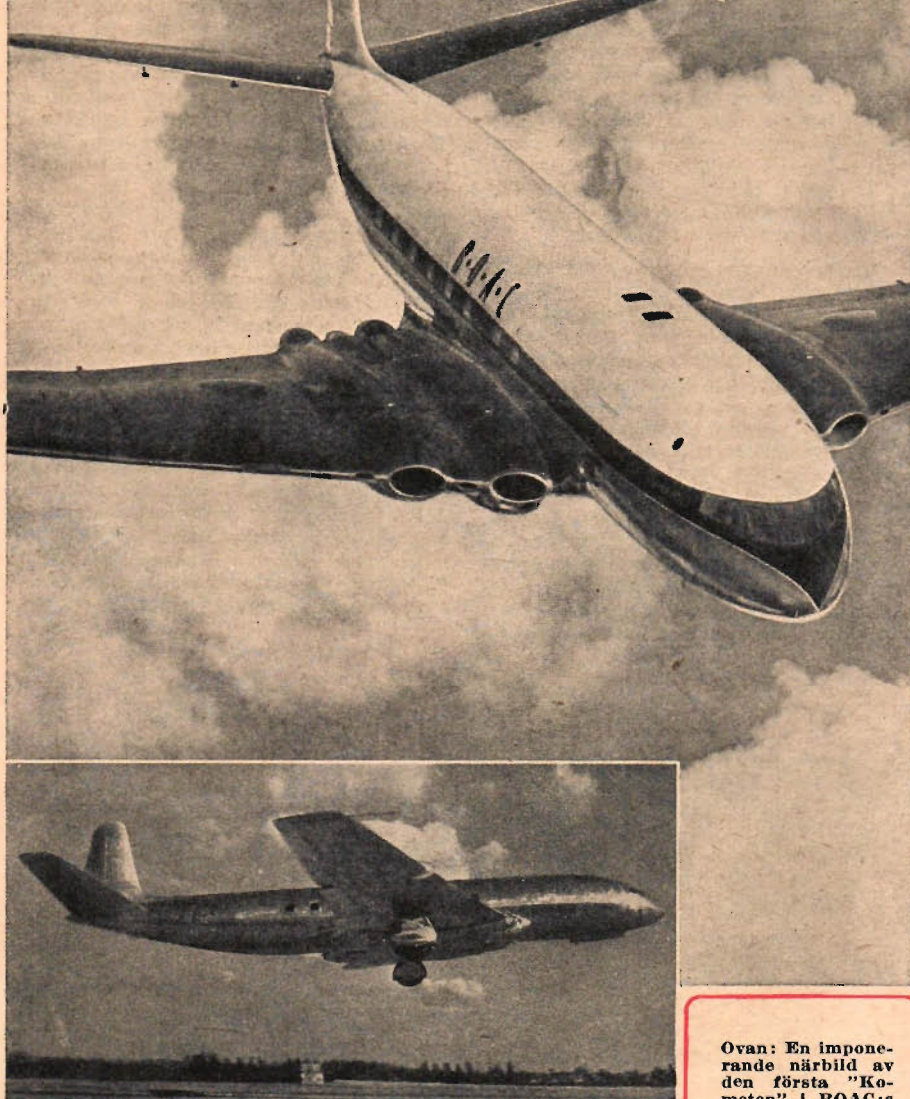
Därunder: En intressant bild av det readrivna trafikflygplanet D. H. 106 Comet under start. Nosstället har redan hunnit in, medan huvudställen endast är halvvägs infällda. Detta plan var det andra i första serien och lyfte för första gången i juli 1950, på årsdagen av det första planets premiär.
