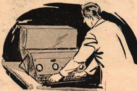
T. v. Bergstrands geodimeter sedd bakifrån i mätläge med de båda sfäriska speglarna fullt synliga. Övan avläsning av mätningens resultat. T. h. schematisk framställning av ljusets gång, dess reflektion i apparatspeglarna och i planspeglarna vid "målet".
