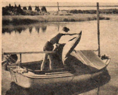
Nylonfilar tvärs över bommen förvandlar sittbrunnen till en behändig ruff. Filtarna hålls sträckta genom linor runt kölen. T. h. hissas segel snabbt och elegant genom att både mast och bom är av lättmetall, ha ingjutna T-spår. Längst t. h. den mycket sjösäkra båten på väg till havs.
