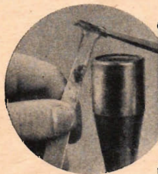
Fig. 3 (cirkeln): Glasrör uppvärms och kragas.
