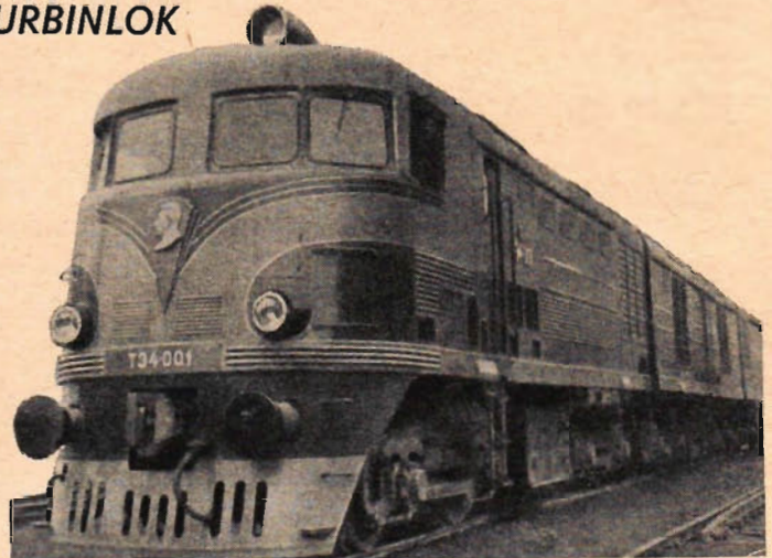
TE-4 lämnar 2 000 hk och är således ett medelstort turbinlok.
