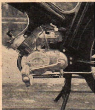
Från pedalens infästning i växellådan går bromsarmen ut till bakhjulets trumbroms på Flandria.
