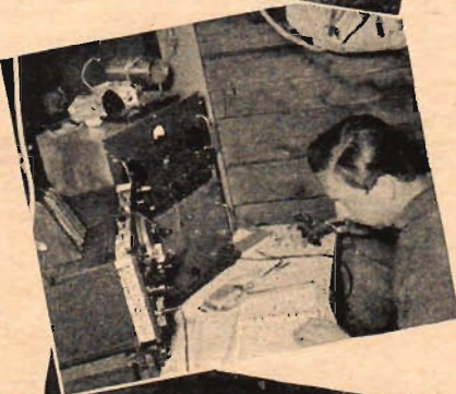
Till en av de portabla UK-stationerna hörde den isärtagbara riktantennen nederst, en fin sak, som med tillhörande station ger en räckvidd på minst 5 mll.
