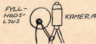
Fig. 3. Fyllnadsljuset placeras så nära kameran som möjligt på motsatta sidan om huvudljuset eller på så sätt att belysningen blir jämn.
