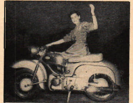
Ett nytt drag var tendensen att göra de rena bruksmaskinerna allt mer inbyggda, för att inte säga scooterlika. Ett typiskt exempel är denna 250 cc Zündapp utrustad med en tvåcylindrig tvåtaktsmotor på 18,5 hk.
