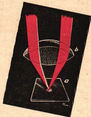
Fig. 1 (ovan). Luppen, det första mikroskopet som människan använde sig av. Fig. 2 (nedan) visar schematiskt ett vanligt mikroskop. Fig. 3 (nedan t. v.) visar principiellt ett reflexmikroskop. Ljuset kommer in genom en kondensor och reflekteras mot en halvklotformad spegel och mot kondensorns skålformiga spegel samt bryts sedan samman.
