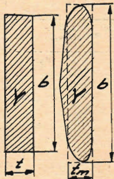
Fig. 4 (t. v.) visar en vingprofil. Fig. 5 (nedan): Bärplanetens data. Medelkordan t_m fås genom att dividera vingytan Y med spännvidden b .
