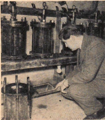
Ovan: Ingenjör Per Olov Jonsson kontrollerar provning av betongs täthet. En betongcylinder placeras i stålmanter, varefter asfalt gjuts omkring. Med ett tryck av 35 kg cm 2 under två dygn undersöks om vatten tränger igenom betongcylindern. Nedan: Ing. Evert Lundin ytfinhetsmäter. Apparaten har en diamantspets, vilken släpar efter ytan. Den profilkurva på ytans utseende som tas upp har en förstoringegrad av intill 50 000 gånger.
