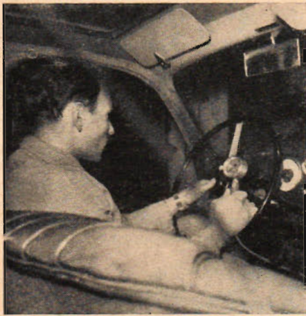
På det instrument provingenjören håller i handen avläser han pedaltrycket vid bromsning samtidigt som en kollega avläser bromskraften på den stora instrumenttavlan.
