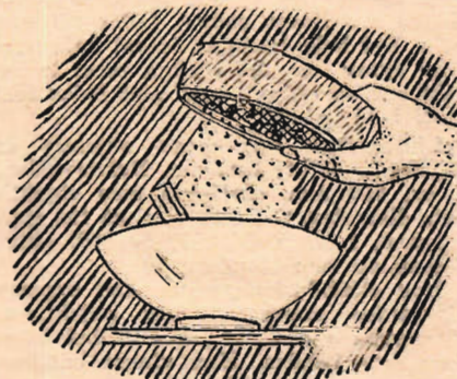
Fig. 4 (ovan). Godset staplas för råbränning. Fig. 5 (nedan). Glasyrn siktas genom ett säll.
