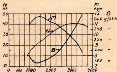
Diagram över motoreffekt (N), vridande moment (M) och bränsleförbrukning hos Vanguard 40 hk dieselmotor.
