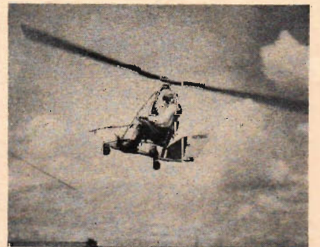
Gyroglidern under bogsering efter bil, vilket går bra då gyroglidern flyger säkert redan vid 35 km/tim.
