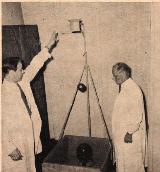
Ingenjör Larsson på Statens institut för folkhälsan släpper en 3,5 kg järnkula från 1,5 m höjd direkt ned på hjälmen medan ingenjör Thrysin intresserat väntar på resultatet.
