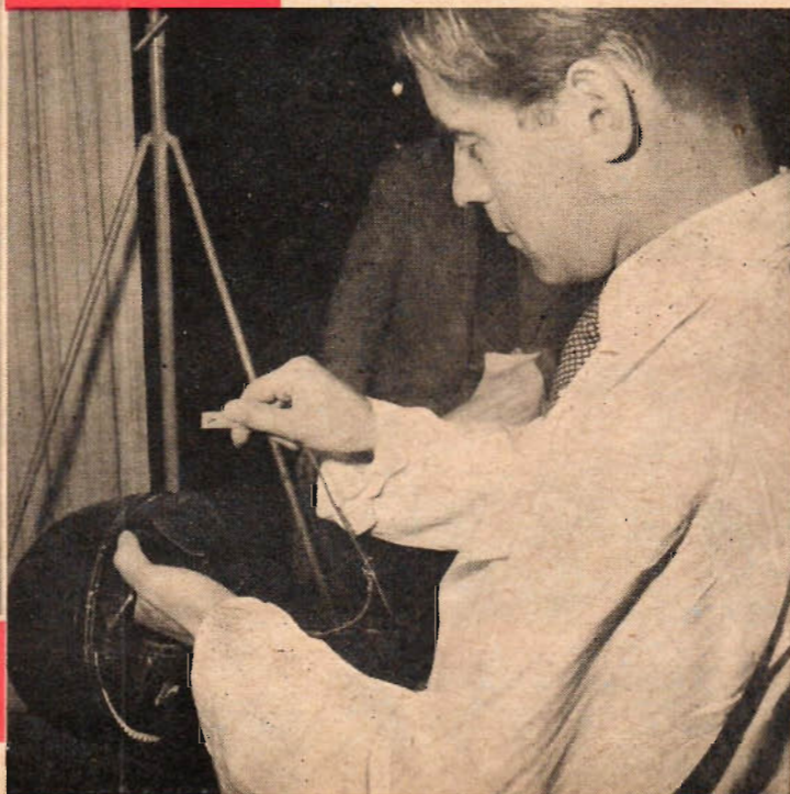
Ingenjör Larsson på Statens institut för folkhälsan släpper en 3,5 kg järnkula från 1,5 m höjd direkt ned på hjälmen medan ingenjör Thrysin intresserat väntar på resultatet.
