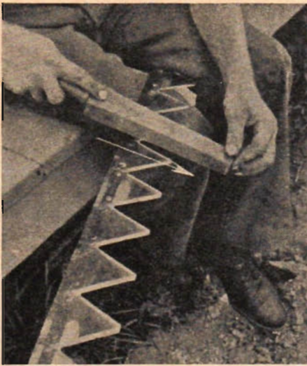
En slättermaskinskniv kan skäras utan att tas bort. Brynet förs på sätt som bilden visar.
