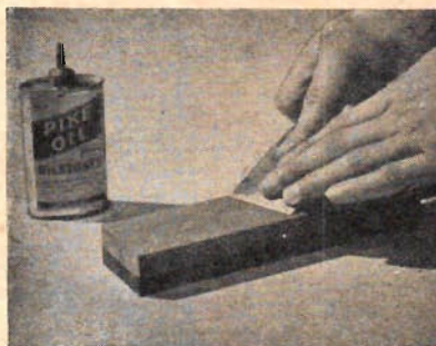
Ovan: Stålets bladvinkel slipas in mot ett bryne genom att föras fram och tillbaka utan att vaggas. Arbetet underlättas avsevärt om jiggen i fig. 3 används.
