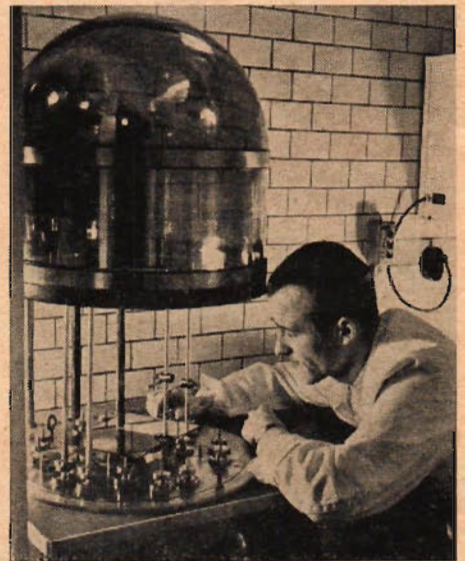
Ingenjör Wikström placerar in ett prov i vakuumkammaren för förberedelse till elektronmikroskopering. Den stora gasklockan sänkes sedan, luften pumpas ur och ett ytterst tunt lager av metallen palladium läggs på provet genom kondensation av palladiumånga.
