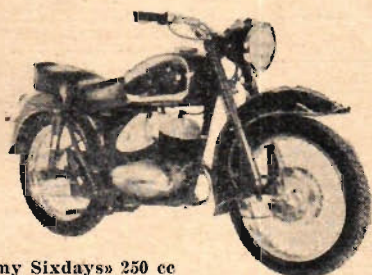
NV 38 »Army Sixdays» 250 cc Dubbel svensk mästare i tunga klassen. »Allvägsfjädringen» med sidstabil swinggaffel bak och bottenlänkgaffel fram samt nykonstruerad ram ger oanad körkomfort! 14.1 hk 4-växlad DKW-motor. S. k. fullnav, stoppljus, stöldlås och hastighetsmätare med trippmätare. Riktpris 2.445: —
