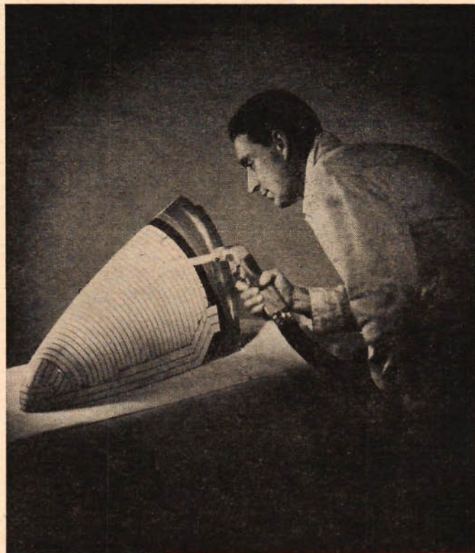
Värmemattan sprutas på en detalj till Bristol Britannia.
