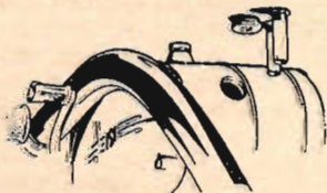
Nedan: Glöm inte att regelbundet demontera och rengöra slanhylsorna, som finns på vevhusets undre framsida!
