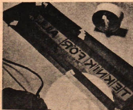
Fig. 3. Glasskivan med bokstäverna läggs över filmen, med bokstäverna nedåt. Exponeringen blir här ca 30 sek med en 500 watts fotolampa på en halv meters avstånd.
