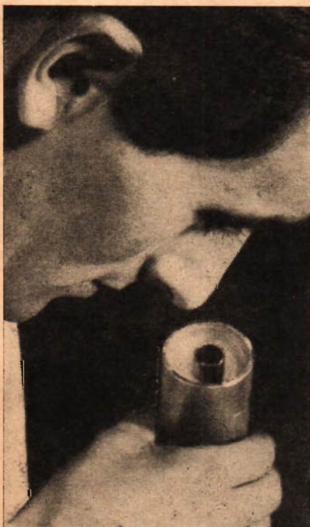
Teknolog Ernst Jonsson synar den viktiga koaxialkabeln — bestående av ett yttre aluminium- och ett inre kopparrör och däremellan en plastmassa, som utgör läak bl. a. mellan sändaren och antennen för överföring av 205—207 Mp/s.
