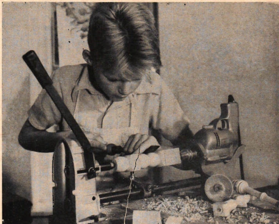
Träsvarven med handborrmaskinen som motor.
