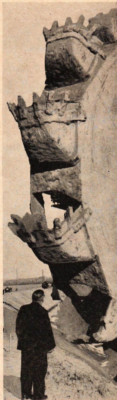
16 meter i diameter mäter det med 12 skovlar försedda skovelhjulet på "Världens största grävskopa", maskinen som i sin helhet väger omkring 5 500 ton.
