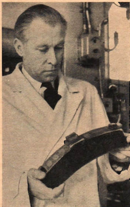
SBF:s nya bromsblock till SJ:s motorvagnar får 4-6 ggr större livslängd än gjutjärnsblock, ger hälften så lång bromssträcka, är nära 3 ggr dyrare och ger ingen gnistbildning. Lokförarna är därför storbelåtna med dem.
