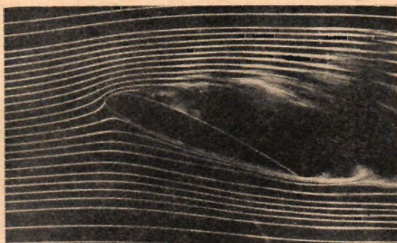
Fig. 4: Dessa fyra bilder visar, hur strömlinjebilderna ändras för en tjock vingprofil vid olika åtgärder. Den övre vänstra bilden visar profilen i stall. T. h. har profilen försetts med en slot i framkanten. Nedan t. v. blåses tryckluft in på profilens översida, och t. h. sugas gränsskiktet bort vid profilens översida.
