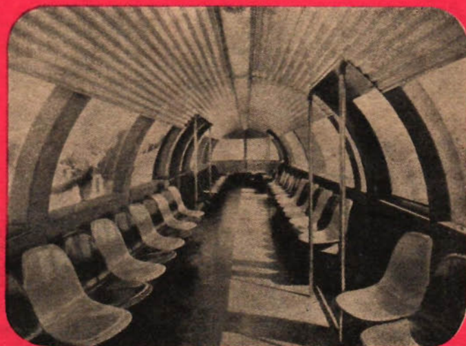
Interiören i Houstonbanans vagnar är luftig och ljus med sittplatser i fiberglas. Sittplatser finns för 60 passagerare och ståplatser för 50.
