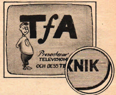
Fig. 2. Hela TV-bilden är uppbyggd av ett linjeraster som elektronstrålens spets ritar upp. Man kan tydligt se rastret om man går tätt in på en TV-skärm.
