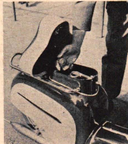
Under sadeln ligger väl skyddat verktygsutrymmet och locket till bensintanken.
