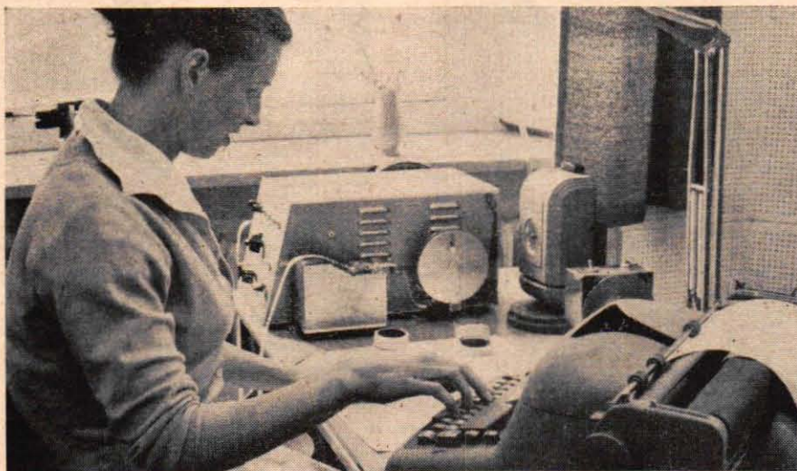
Ett arbetsproblem för Facit EDB och instruktioner om hur problemet ska lösas förs över till hållremsa via en elektrisk skrivmaskin och ett stansaggregat. Flickan som gör det kallas programmerare.
