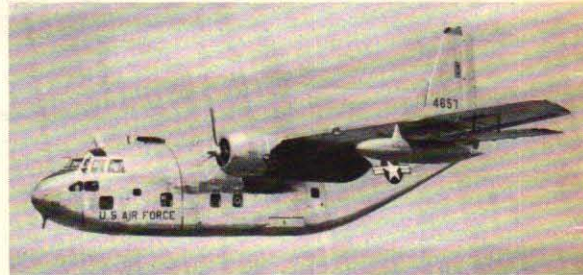
Bilden visar Fairchild C-123 i luften. Trots den fantastiska lastkapaciteten kan planet landa på provisoriska flygplatser med gräsbanor. Spännvidden är 33 m och längden 23 m. Två Pratt & Whitney-motorer ger planet maxfarten 385 km/tim.
