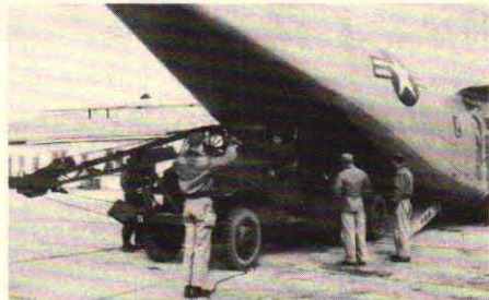
USA-flygets transportplan Fairchild C-123 kan alternativt ta 60 fältutrustade soldater, en 15 cm haubits med ammunition eller en 2,5 tons lastbil med ca 1 700 kg last. In- och urlastningen sker enkelt genom den nedfällbara lastrampen.
