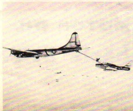
Bränslepåfyllning i luften bidrar i hög grad till att öka jaktflygplanens räckvidd. Här lufttankar en av det amerikanska flygets Republic F-84F Thunderstreak. Planet kan medföra, en taktisk atombomb och har en topphastighet av ca 1 140 km/tim.
