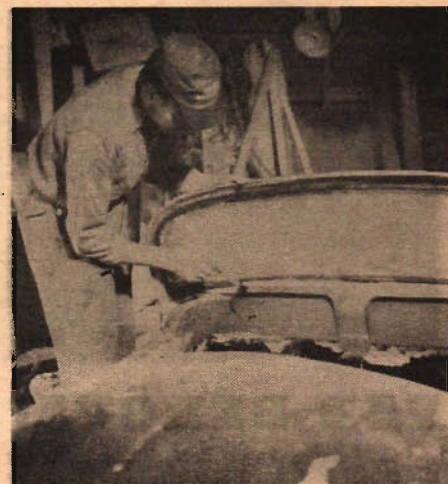
Gipsmodellen är färdig och instrumentbrädan är spacklad för slipning. Vindruterasmen behöver bara slipas på utsidan då insidan inte gjuts av.
