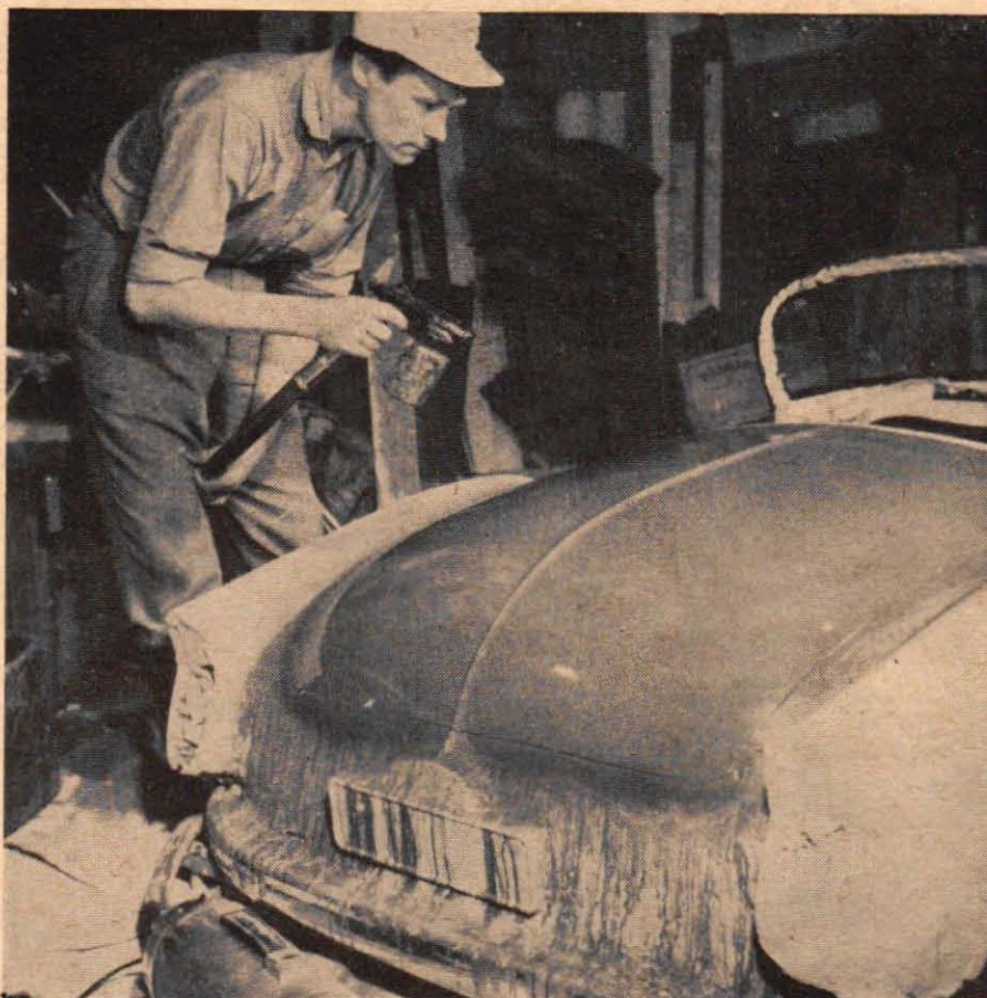
I förra numret berättade vi om ytbehandlingen före formgjutningen. Så här går det till när modellen lackeras i originalfärg efter slipningen. Ytan poleras och vaxas sedan till fullkomlig höglans.
