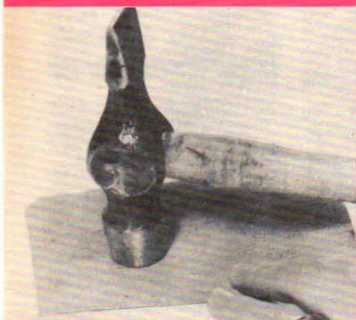
Om hammarhuvudet är glatt glider spiken och man slår sig lätt på fingrarna. Detta undviker man genom att slipa hammaren med grovt sandpapper.
