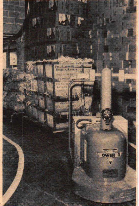
Guido-O-Matic är en varutruck som kan köras utan förare. Den kan antingen fjärrstyras elektroniskt efter en ledning i golvet eller manövreras på optisk väg, då den följer en målad linje på golvet.
