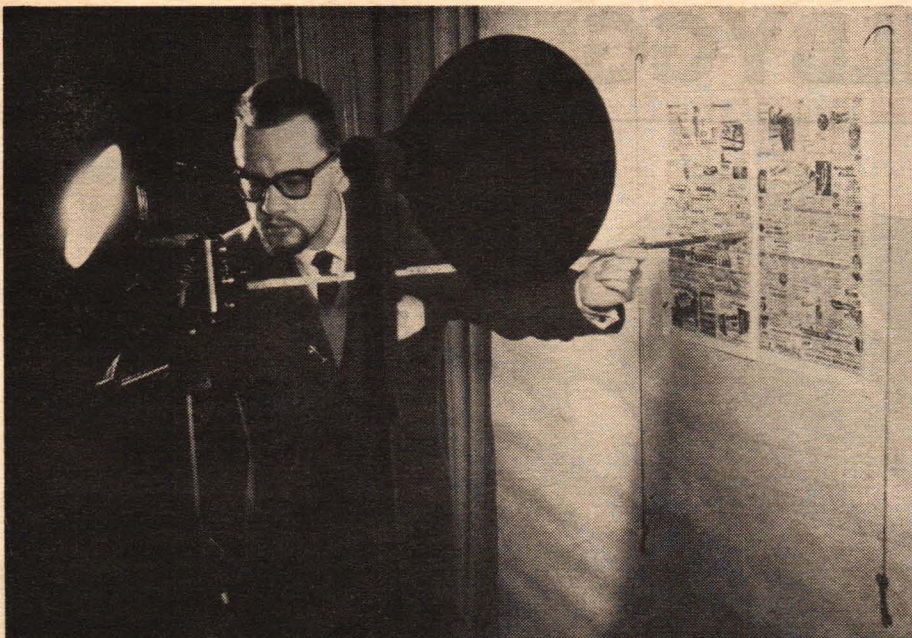
Det går mycket bra att testa ett objektivs skarptecknande förmåga samt kamerans avståndsställning med så här enkla medel. En tidning på väggen, en fotolampa och ett stativ är allt vad som behövs.
