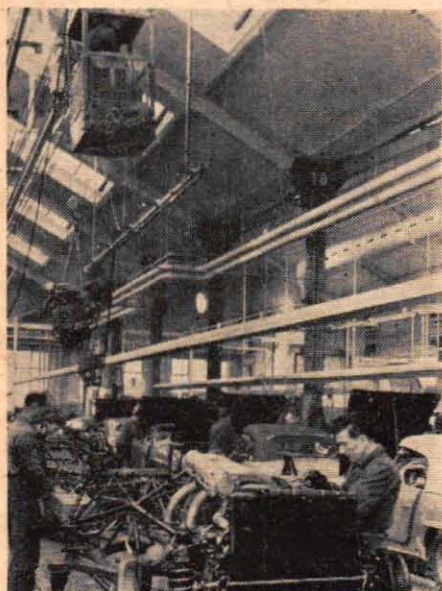
3 Sedan motorn monterats, kompletteras ramen med kylare, kraftöverföring, fjädring m. m. Observera bromstrummornas flänsar för bättre kylning.
