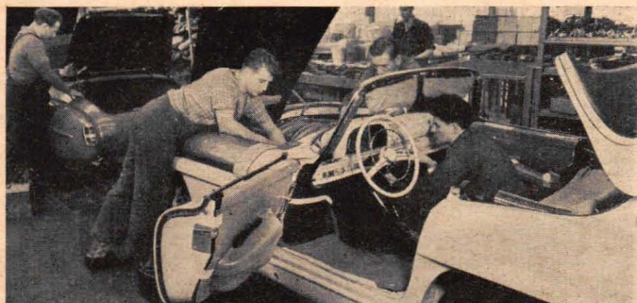
7 Ett tränat gäng specialarbetare tar itu med den läckra kombinationen av kaross och chassi. vagnen rullar inte på egna hjul ännu, utan på bockar med "tevagshjul", som följer ett spår i golvet, här mitt i bandet för "lillebror" 190 SL. Nu inkopplas bl. a. manöverreglage och alla instrument.
