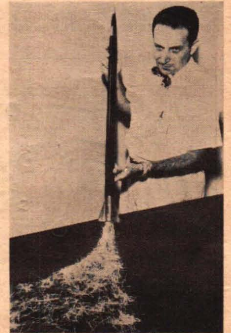
Raketen Loki II är de amerikanska robotarnas värdelots. På hög höjd faller den små aluminiumblad och genom att radarobservera aluminiumbladen kan meteorologerna bedöma vindförhållandena.
