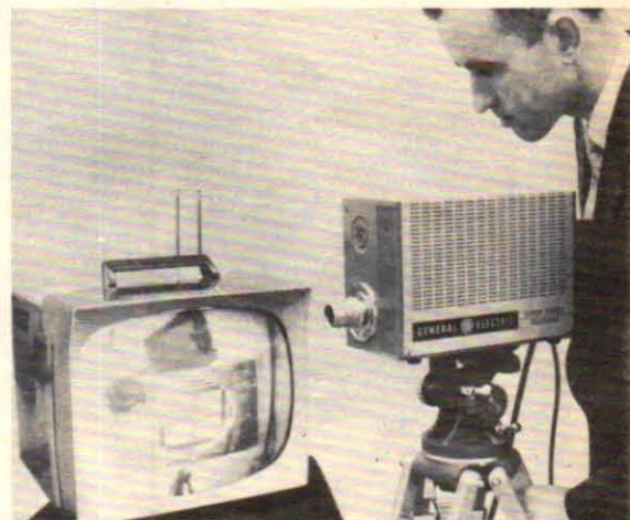
Världens kanske minsta TV-kamera, General Electrics TE-6A, återger här en testbild på en 14 tums bildruta. Denna nya TV-apparat är så billig att den i USA används i hushållen, där t. ex. husmor kan hålla ett öga på barnen via TV-kameran i trädgården och en TV-apparat i köket. Den nya kameran är dock främst avsedd för industri-TV.
