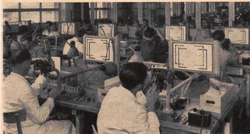
Kontroller och återkontroller sätter sin prägel på tillverkningen. Övan finjusteras tiderna för en Leicas ridslutare med hjälp av ett känsligt mätinstrument. Bilden nedan visar den del av monteringshallen där man gör den avslutande trimningen av den nya Leica-modellen M 3:s bildrumsökare. Det är ett omfattande arbete att montera en kamera. En enda Leica-kamera kräver hela 8 049 arbetsmoment...
