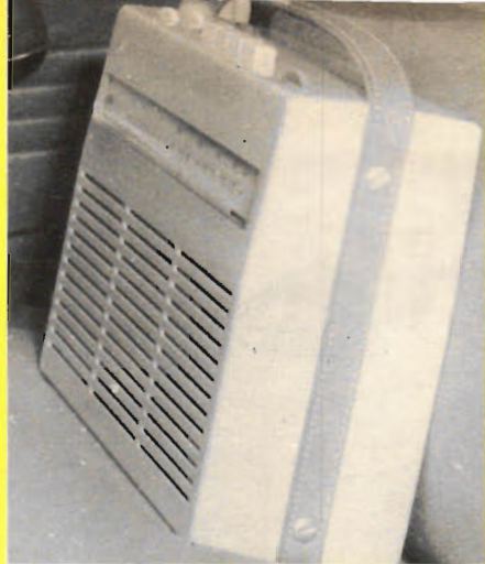
En bilradio, som kan tas ur bilen och användas på campingplatsen, i sommarstugan eller som extraradio hemma i våningen är Brauns nya batterimottagare Transistor 2. Apparaten kan dessutom anslutas till grammofon och bandspelare.
