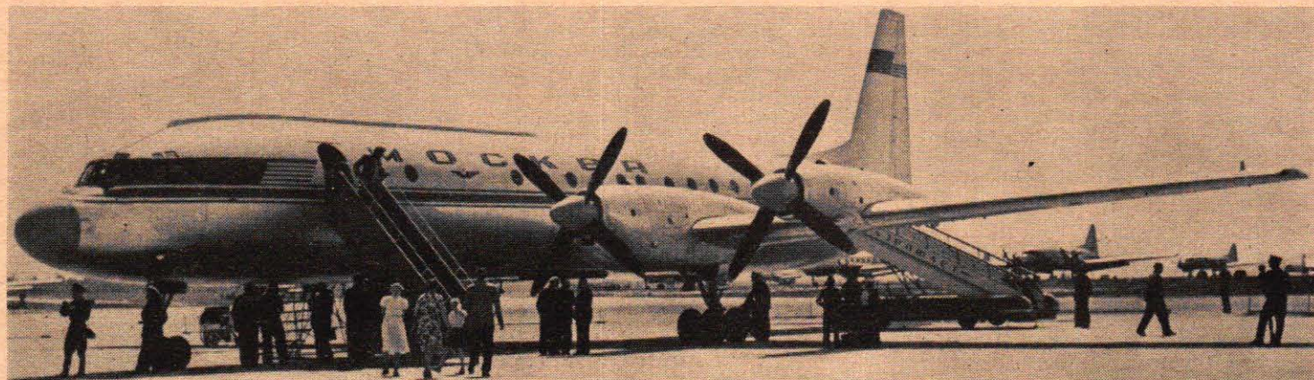
Inredningen i Moskva är av hög standard med moderna flygplansfåtöljer etc. (ovan). Bilden nedan visar Moskvans linjesköna exteriör. Det lågvingade planet har fyra turbopropmotorer, som tillsammans presterar inte mindre än 16 000 hk.
