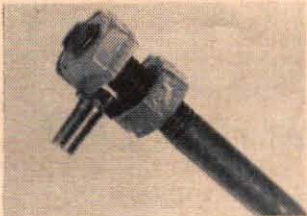
En bult med två muttrar kan användas som skiffnyckel enligt bilden.
