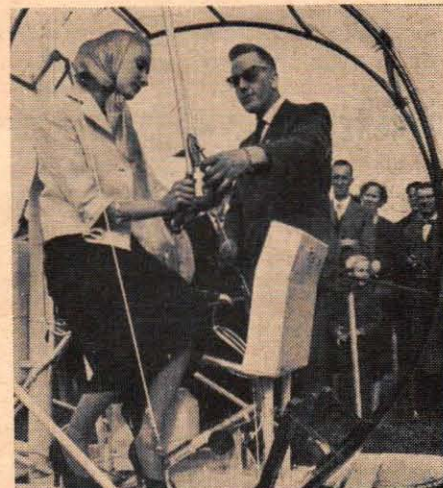
Smälänningen Olle Johansson från Södra Vi har i två års tid arbetat på den här hemslöjdshelikoptern. På bilden ovan provsitter han förarhytten och nedan demonstreras "snurrans" styranordning. Helikoptern har två reamotorer av modellflygtyp.
