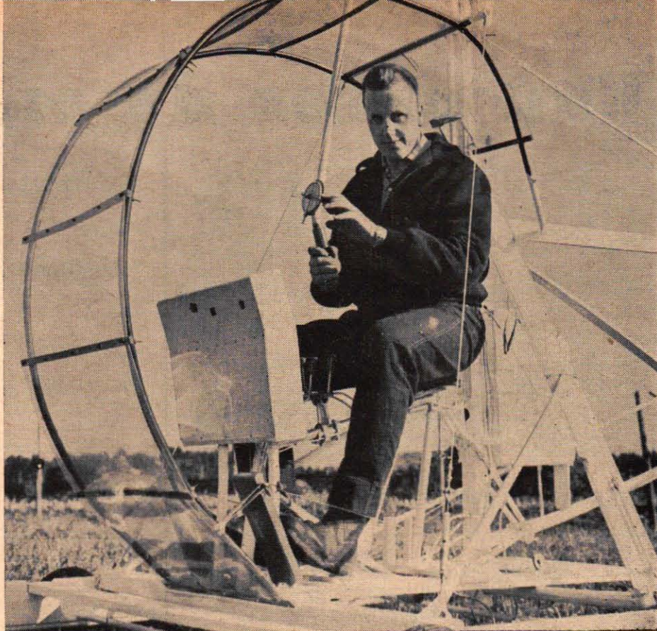
Smälänningen Olle Johansson från Södra Vi har i två års tid arbetat på den här hemslöjdshelikoptern. På bilden ovan provsitter han förarhytten och nedan demonstreras "snurrans" styranordning. Helikoptern har två reamotorer av modellflygtyp.
