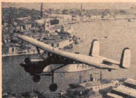
Den franska flygfabriken Max Holste bygger det högvingsade monoplanet Broussard för både militärt och civilt bruk. Broussard, som har plats för sex personer, har förhållandevis kort start- och landningssträcka. Maxhastighet 270 km/tim.
