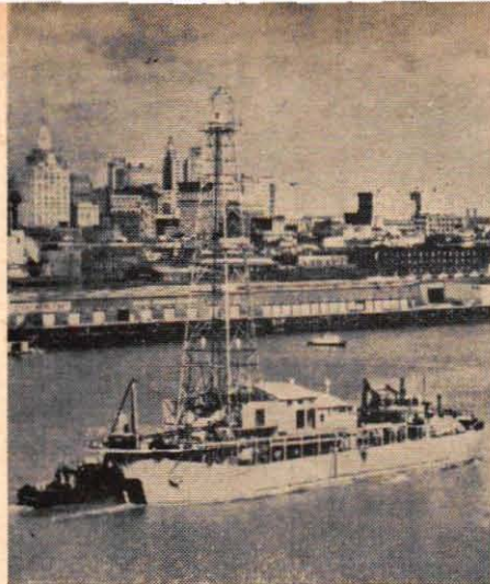
2 Enda sättet att konstatera om det finns olja är att borra efter den. När de förberedande undersökningarna är klara vet man var borrningen skall ske. Borrplattformen ovan är ett ombyggt landstigningsfartyg från senaste världskriget.
