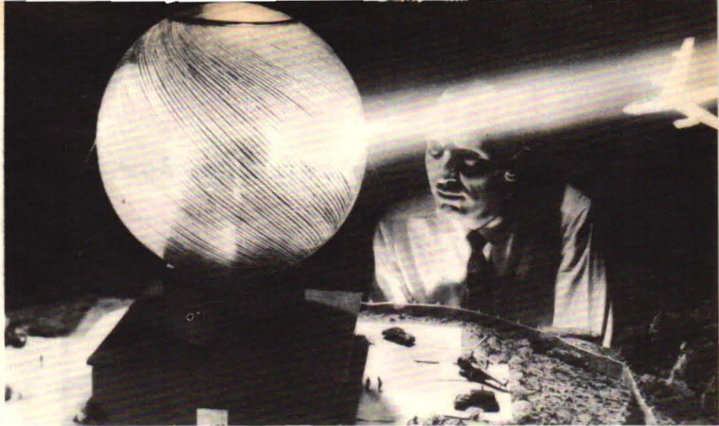
Helisphere heter den här nya formen av radarantenn, som nu testas i USA. Radarvägorna sänds från en roterande sändare inne i jättegloben, reflekteras och sänds vidare i ett strålknippe. Bilden visar den nya radarantennen i modell. Man har planer på att bygga en sådan antenn med 30 m höjd för att användas vid någon av den amerikanska krigsmaktens spaningsstationer för antirobot-bevakning.
