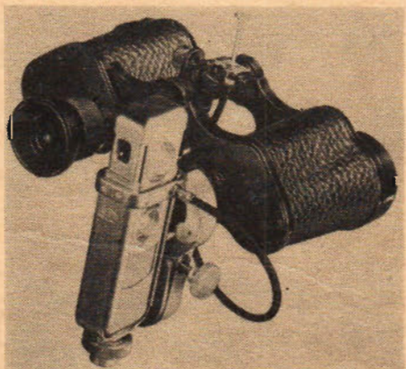
Det går också att ta fjärrbilder med Minox-kameran. Man använder då en vanlig kikare som "teleobjektiv". Kikaradaptern består av en särskild fästordning för kameran med hållare för trödlösare och specialmutter för montage på stativ.
