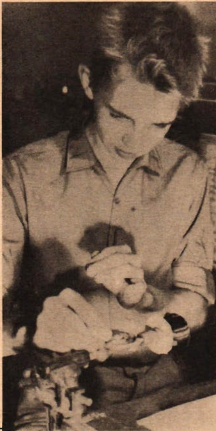
Ett praktiskt sätt att linda en elektromagnet illustreras på bilden här ovan. Man tar en vanlig handbormaskin, fäster den i ett skruvslycke och fäster spolen på ena axeln i maskinens chuck. Sedan är det bara att veva upp koppartråden.
