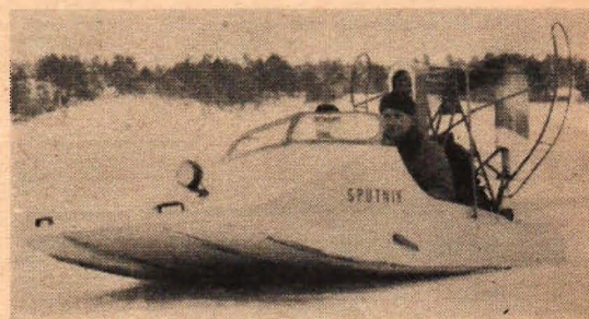
På bilden överst ses Albin Johanssons amfibie komma susande från öppna havet och glida upp på iskanter. Närmast ovan ses "landstigningen" i närbild. Under botten sitter två kraftiga, bockade järnrör som skidor och i ytterkanterna har konstruktören placerat kantställda vinkeljärn.
