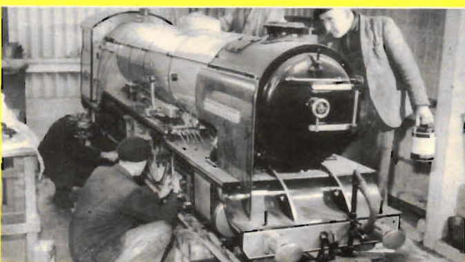
Världens minsta järnväg med passagerartrafik är Romney, Hythe och Dymchurch-banan i England. Banan är 22 km lång och spårvidden är 38 cm. Här sker vinteröversynen av dvärgloket "Southern Maid", som får förslitna delar utbytta och en allmän uppsättning inför vårens trafikpremiär.
