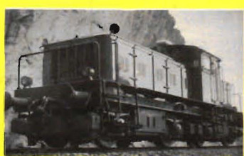
Hägglands i Ornsköldsvik har nyligen levererat två helsvenska dieselhydrauliska boggielok till LKAB i Kiruna. Loken, som har hydrauliska växlar, har en vikt av 52 ton och dragkraften vid start är 20 000 kgf.
