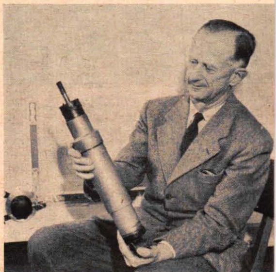
De göteborgare som träffade på "spökvolvon", behöver inte grubbla längre. Vagnen var utrustad med "Wettsteins luftfjädring", som närmast ovan demonstreras av uppfinnaren själv, diplomingenjör Fritz Wettstein. De unika bilderna överst visar hur smidigt fjäderelementen byggdes in i en PV 444.
