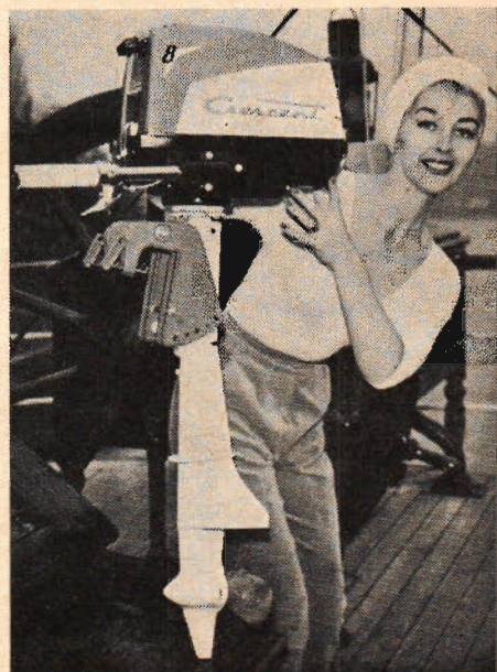
Nya Crescent Marin 8 är en vattenkyld tvåcylindrig tvåtaktare med en cylindervolym på 140 cc. Motorn har automatisk upplindning av startlinan, är svängbar för backning och har frikoppling. Effekten är 8 hk och bränsleförbrukningen är ca 3 l/tim. Motorn kostar 1 490 kr och väger 17 kg.
