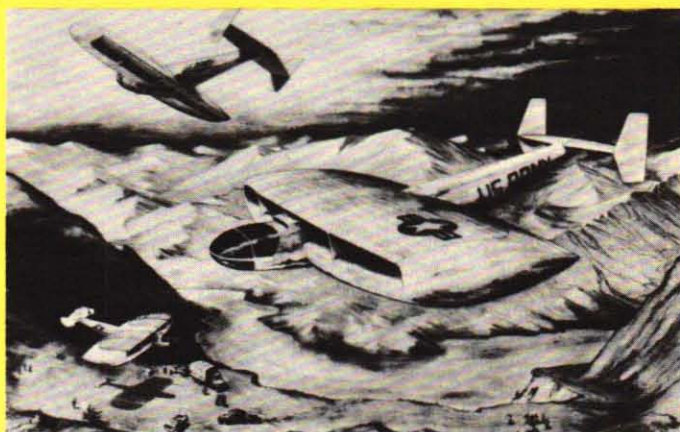
Convoplane kallar Goodyear detta vertikalstartplan, som för närvarande undergår aerodynamiska prov hos Goodyear Aircraft Corporation i USA. I de fjocka vingarna finns rotorerna, som dirigerar luftströmarna antingen uppåt eller nedåt. Luftströmarna dirigeras genom jalousi-liknande anordningar på vingarnas ovansida och undersida. På planet längst ned t. v. är ving-jalousierna öppna och ger vertikalstartplanet helikoptergenskaper.
