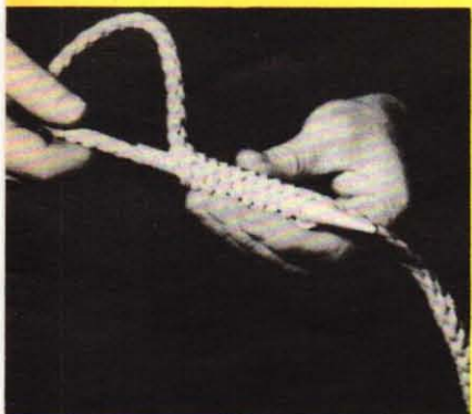
I förra numret berättade vi om några nya och praktiska båtillbehör från Rös-Marin i Stockholm. T. v. ser vi det nya amerikanska polyeten-lågvrivet, som kan splittas i en handvändning med hjälp av ett enkelt specialverktyg. "Nålen" sticks in, och när den dragits ut är splitsen klar. T. h. ser vi två frihållare av Polvas mjukplast. Fjädringen regleras helt enkelt genom att man fyller på vatten. Plastfrihållarna kan även användas som vattenbehållare.
