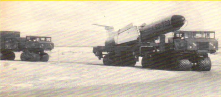
Martin Mace är namnet på ett amerikanskt taktiskt robotvapen, som bl. a. skall tilldelas Atlantpakt-styrkorna. Bilden visar ett Mace-förband på marsch. Roboten och dess katapult transporteras på en specialbyggd jättestabil följd av en stor radarvagn. Lagg märke till bilarnas specialdäck.
