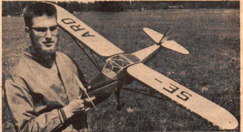
Hammars Auster Autocraft vann i modellpoäng som tävlingens flattaste plan. Modellen hade en Elfimotor på 1,5 kubik och en sådan finess som pendelroder. Originalen flyger för Stockholms Aero.
