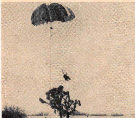
Fallskärmsutlösningen är automatisk. När stolen fallit till en viss höjd, utlöser ett höjdmätare-kopplat reglage en mindre bromsfallskärm. Efter någon sekunds bromsning fälls huvudfallskärmen ut, varefter "piloten" frigörs från katapultstolen.
