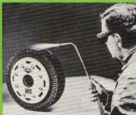
Svetslågan bitar inte på detta däck, som konstruerats av Goodyear. Däcket skall användas på landningshjul för rymdraketer och skall motstå påkänningarna då raketen passerar värmevallen.
