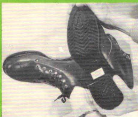
En ny typ av neoprensulor för arbetsskor kan vulkaniseras direkt till ovanlådret utan stickningar, varigenom fukt och frätande kemikalier hindras tränga in. Skorna blir mycket smidiga.
