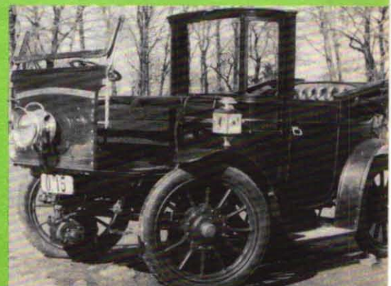
Intresset för gamla bilar är stort i Sverige och till en bilexpo i Göteborg hade bl. a. en Krieger tillverkad i Frankrike 1904 plockats fram. Åket drivs med en el-motor på vardera framhjulet. Ackumulatörerna väger 800 kg.
