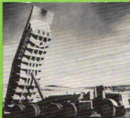
Hela 165 ton lastar denna amerikanska "tungviktslastbil", som rullar på 18 däck av dimensionen, 18x33. Flakets framkant är 13 m över marken, då lasten tippas. Toppfarten ligger på 55 km/tim.
