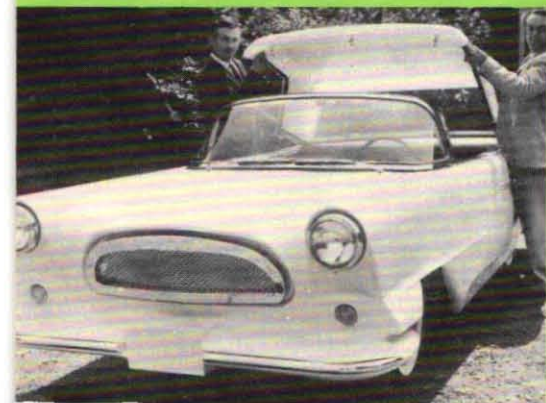
För USA-marknaden är den här nya plastbilen tänkt. Shamrock heter modellen, som har Austin A 55:s motor och även i övrigt BMC-detaljer under plastskalet. Tillverkningen förlägger man till Irland.
