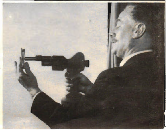
Nitningstekniken har utvecklats i våldsam takt under senare år. Ett exempel på modern nitning är Huck-Bolt, som här demonstreras. Nitpistolen griper tag i den utskjutande delen av bulten, drar in den tills de båda metallstyckena möts och biter sedan av det "överblivna" stycket.
