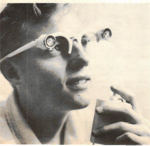
Lysande glasögon för bilisten presenteras av AB Noco i Malmö. Meningen är att glasögonen, som ansluts till separat batteri med strömbrytare, skall användas vid reparationer eller annan biltillsyn, när man inte med gott resultat kan använda en vanlig lampa. Kronor 23: 50 kostar lysglasögonen.
