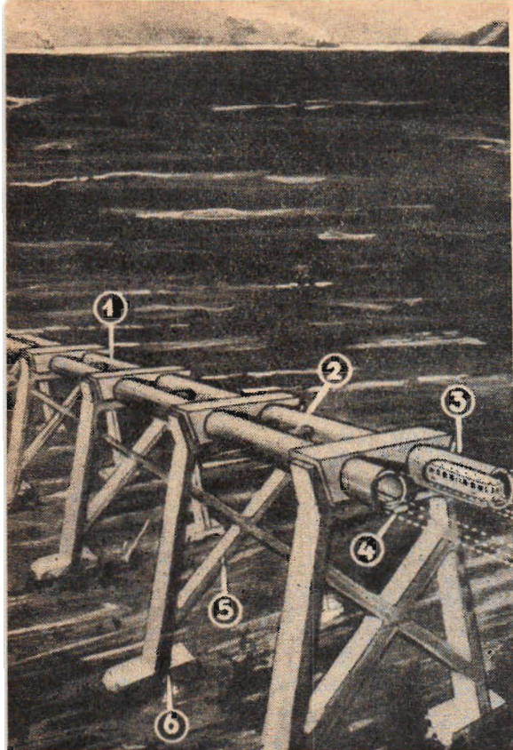
Enligt ett av de mera bisarra tunnelförslagen (ovan) skulle två tunnlar (1 och 2) ge utrymme för expressståg i vardera riktningen (3 och 4). Tunnlarna skulle vila på en undervattensbro (5 och 6). Nedan visas konstruktionen i genomskärning. På pelarna J vilar fundamentet T. Q visar ventilationsschakt och N rör för telefonledning.
