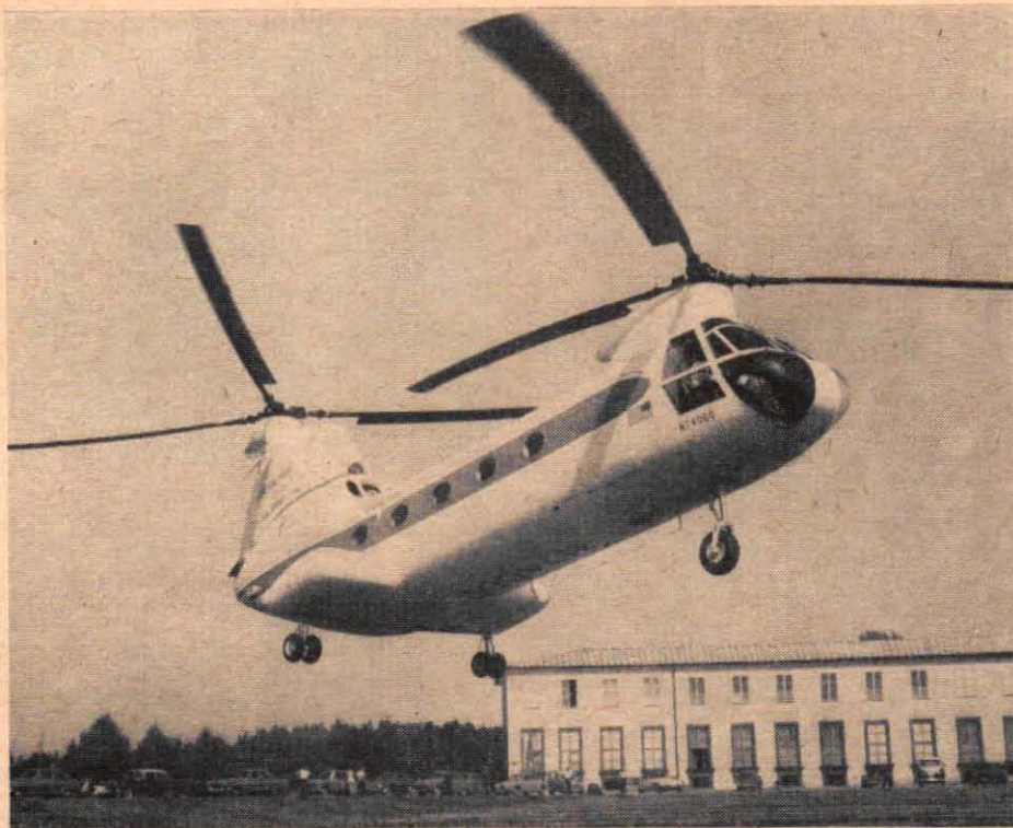
Genom turbinmotorernas höga placering under den bakre rotorn kan hela kroppen utnyttjas som kabin. Vertol 107 är 2,4 m kortare än Vertol 44 men har trots detta mer än 50 procent större kabinutrymme. En lastramp i akterpartiet tillåter snabb lastning och mindre fordon kan köra rakt in i helikoptern.
