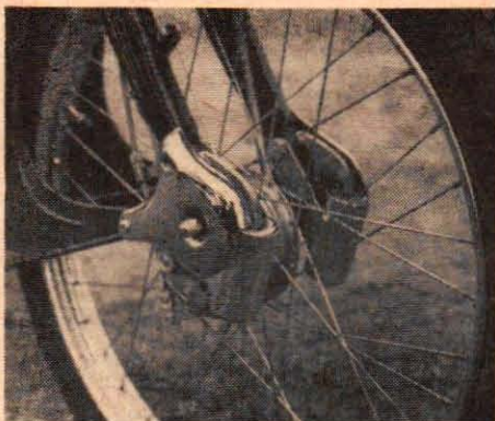
Trots den vackra och i någon mån kamouflerade utformningen av framhjulens fjädersystem, har Prior-mopeden en helt konventionell bottenlänkfjädring. Denna avfjädras genom spiralfjädrar.
